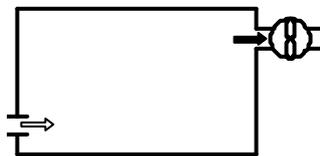
図3 - 5 第3種機械換気設備
