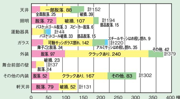
表2. 屋内運動場における非構造部材の被害
