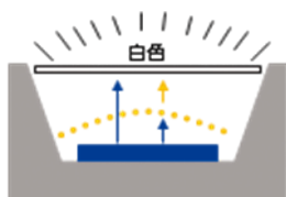
図－19 青色LEDと黄色蛍光体の概念 出典：ローム㈱資料
