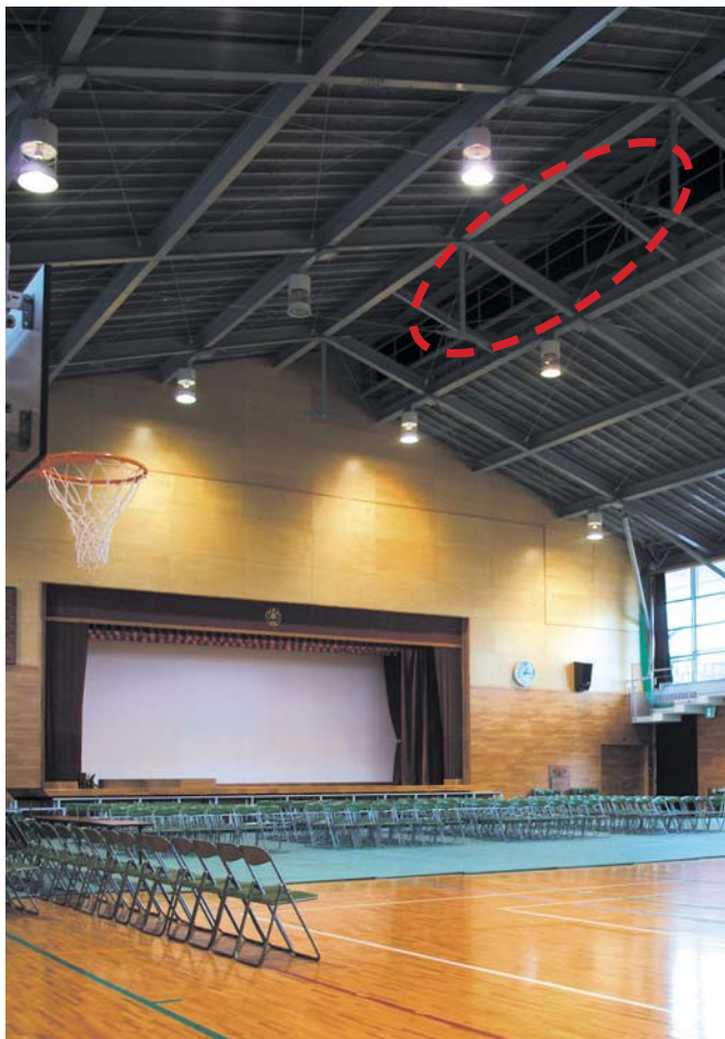
10 室内外の温度差により生じる気圧差を利用した重力換気システムを設けた体育館
