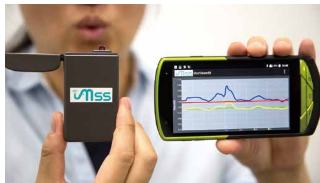
嗅覚センサによる呼気測定（提供：物質・材料研究機構）
