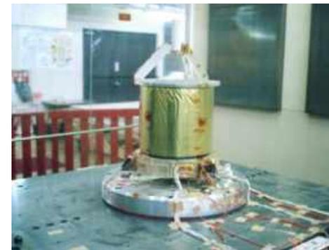
低熱膨張ガラス製光アンテナのプルーフ試験の様子
