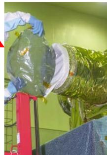
光アンテナに対しては、防塵布と帯電防止シートの2枚を組み合わせ、粒子状コンタミネーションと分子状コンタミネーションの両方からの汚染を防いだ
