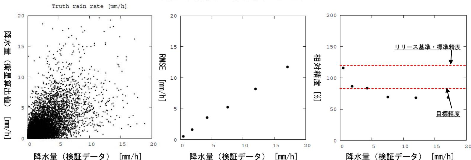
衛星搭載のマイクロ波放射計による陸域降水量算出の参考事例。横軸が検証データ、縦軸が衛星搭載マイクロ波放射計による算出値を示す。
