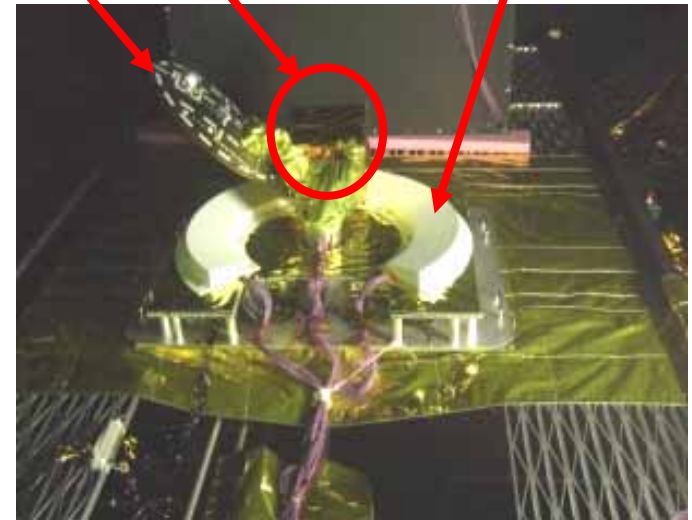
熱制御パネル評価のための熱真空試験
