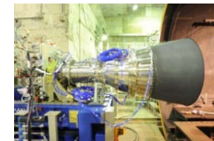
高空燃焼試験 (JAXA角田)
