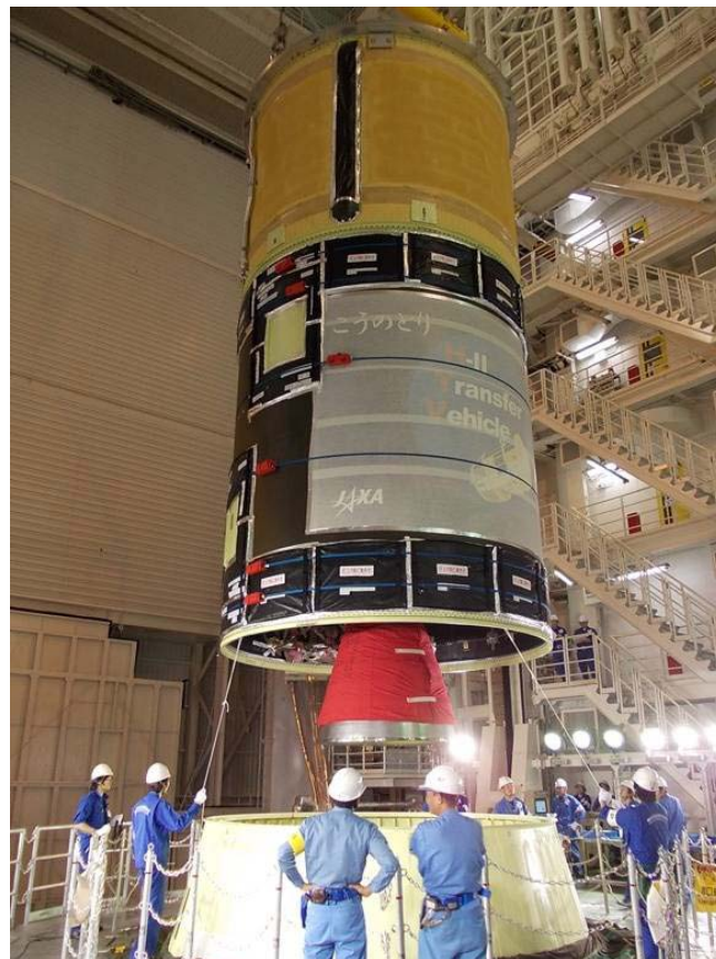
第1段・第2段結合 (H24.3.18完了)
