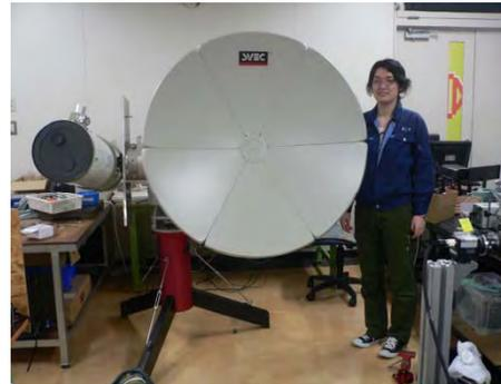
赤道儀に取り付けた反射望遠鏡とパラボラアンテナ
