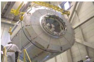
船内実験装置／材料／消耗品等の軌道上貯蔵に用いる。ラック8個を搭載可能。
