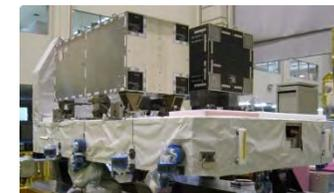
HTVにより船外実験装置等の地上-きぼう間輸送に用いる。ロボットアームにより船外実験プラットフォームに設置される。（\*HTV曝露パレットはHTVの構成要素）
