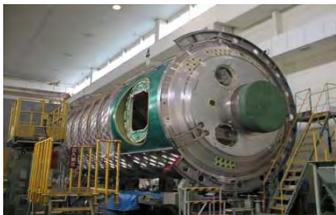
1気圧の環境下で搭乗員が宇宙服を着用することなく、微小重力実験を行うことができる実験室。実験ラック10個を搭載可能。
