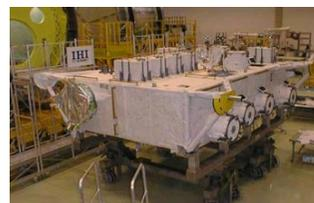
実験装置を直接宇宙空間にさらして、地上では得難い微小重力、高真空の環境を生かした実験等を行うことができる。船外実験装置10個を搭載可能。
