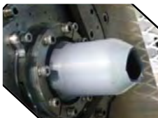
検証試験で破損した燃焼器 (燃焼試験その1)
