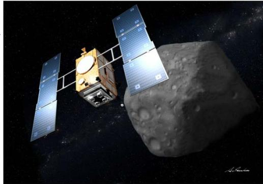
探査機によるリモートセンシング観測では、光学カメラ、赤外線分光計、LIDAR(距離測定)などの機器を用いて、小惑星の特性を調べる。その後小惑星の近接観測、小型ローバの投下、表面試料の採取を行う。
