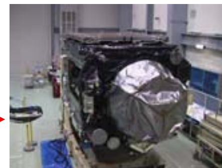
衛星組立後電気性能試験 (2009.11.21-11.22)
