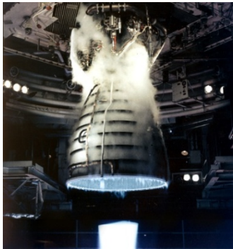
主エンジン 燃焼試験 (1975~)
