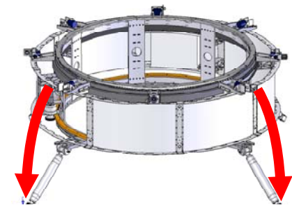
アクチュエータとバネヒンジにより回転ガイドを解放
