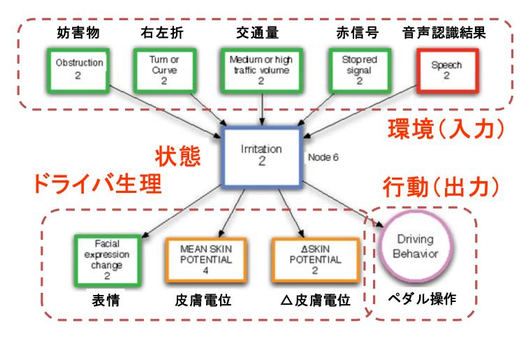
• 環境、ドライバ状態、ドライバ生理、ドライバ行動の関係を ベイジアンネット(確率的因果関係)によりモデル化。
