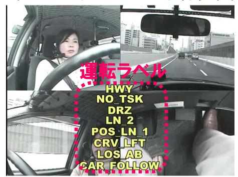
HWY:高速道路、NO\_TSK:平静運転、DRZ:雨、 LN\_\*:車線数、POS\_LN\_\*:現在の車線、LOS\_AB:交通量、 LN\_ENDS\_IN:合流地点、CAR\_FOLLOW:追従走行、 FACE\_POS:明るい表情、HEAD\_OTHER:顔が外を向く
