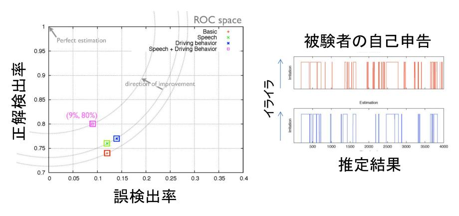
• 環境入力に「音声認識結果」を行動出力に「ペダル操作」を加えることで、誤検出率が30%削減。行動を確率 システムとして捉え、複数情報を統合する効果を確認。
