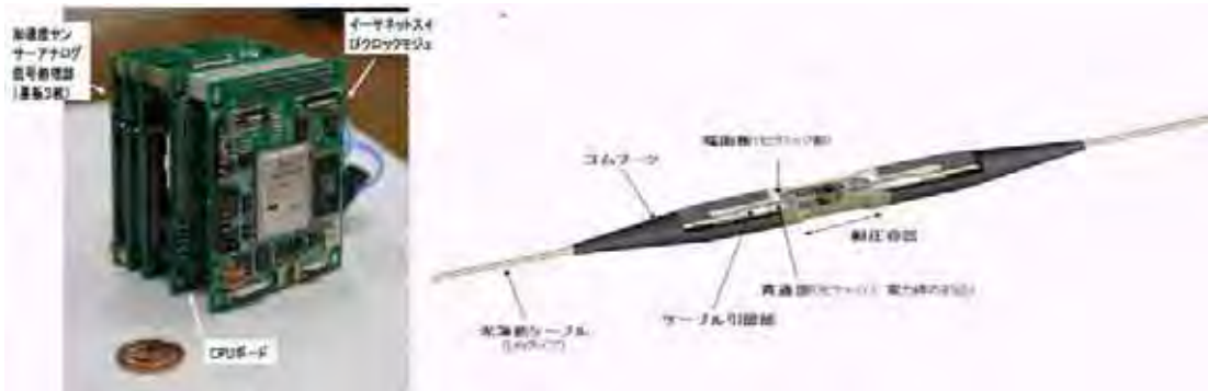
地震観測ノードの内部エレクトロニクス（左図）および地震観測ノード地震計の耐圧容器断面模式図（右図）（東京大学地震研究所 [課題番号1418]）。
