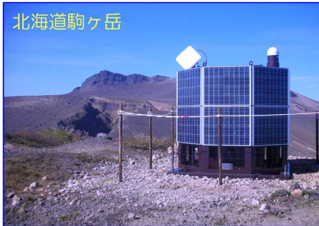
更新したREGMOS。発電効率が向上・耐風性強化。
