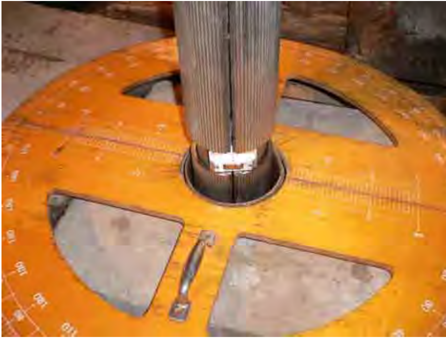
図 49：新たに開発されたボアホールジャッキ式応力測定プローブ。神岡鉱山跡津川坑内のボアホールに投入される直前。図中、油圧ジャッキが図中左右に開きボアホール壁を押し、きれつを押し開く。図の中央部がきれつ開口を検出するための変位センサー。東京大学地震研究所[課題番号：1419]。
