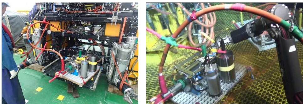
移動型校正用水圧計をROVにより運搬し、海底で稼働中の水圧計の現場校正を行う際のイメージ
