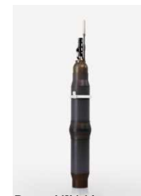
Deep NINJA (JAMSTECと鶴見精機が開発した深海用フロート)
