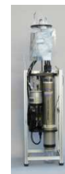
pHセンサ(198×198×960mm、重量 10kg) ⇒無人プラットフォーム搭載に向け、小型化、省電力化、精度向上
