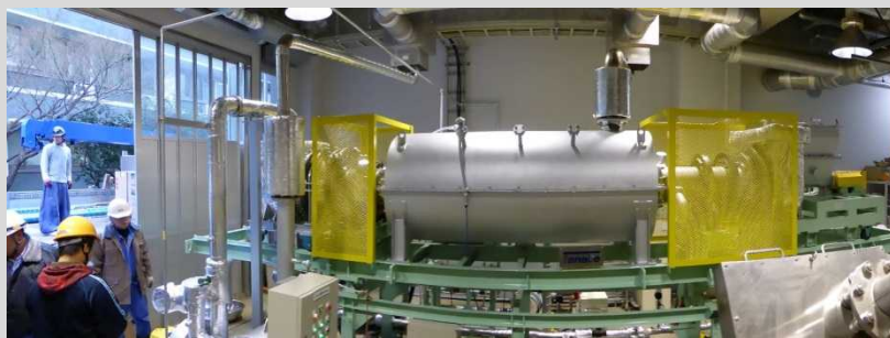
過熱水蒸気土壌脱脂装置実証機
