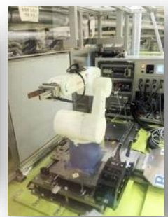
BL20材料構造解析装置 試料入出、試料交換機への搬送
