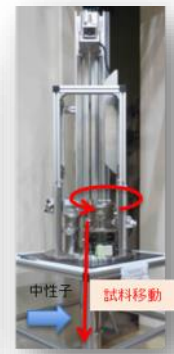
BL21高強度全散乱装置 (試料数: 18、温度: 20~750K)
