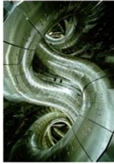
我が国独自のアイデアに基づき超伝導コイルを用いた世界最大のヘリカル型実験装置「大型ヘリカル装置(LHD)」により、高温高密度プラズマの実現と定常運転の実証を目指す。
