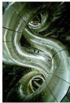
我が国独自のアイデアに基づく超伝導コイルを用いた世界最大のヘリカル型実験装置「大型ヘリカル装置(LHD)」により、高温高密度プラズマの実現と定常運転の実証を目指す。
