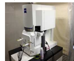
自動切削装置内蔵型の走査型電子顕微鏡。数千枚の連続撮影が可能
