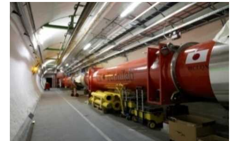
陽子ビームの衝突頻度の向上に重要な役割を果たすLHCビーム衝突点超伝導電磁石
