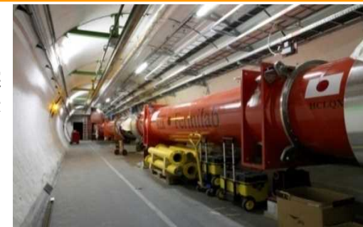
陽子ビームの衝突頻度を上げるために重要な役割を果たすLHCビーム衝突点超伝導電磁石
