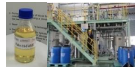
タイ科学技術研究院(TISTR)内に設置されたパイロットプラント(1トン/日規模)とH-FAME燃料。通常の燃料製造施設内に付帯設備として設置可能。
