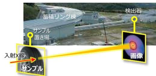
物質中の百ナノメートル（ $10^{-7}$ m）領域の構造体のサイズや形状を測定。極めて小さな角度（10万分の1度以下）で散乱するX線を観測することで、極微小領域の構造解析が可能。→ [ゴム分子中のシリカ粒子（補強材）がつくるネットワーク構造を解明](#)。
