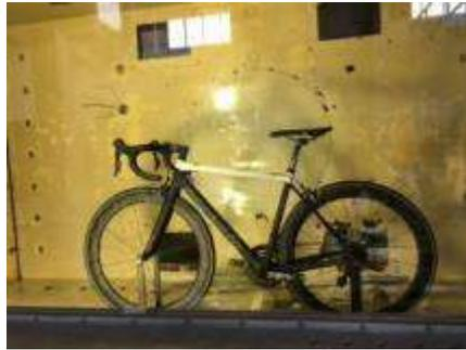
試験状況 (JAXA 2m×2m低速風洞)
