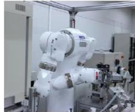
例1) まほろ (バイオ産業用汎用ヒト型ロボット：ラボドroid)
