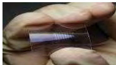
アモルファス酸化物半導体 フレキシブルトランジスタ \text{InGaO}_3(\text{ZnO})_5
