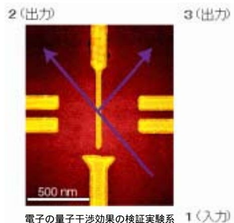
電子の量子干渉効果の検証実験系
