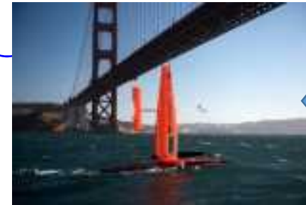
Saildrone：風力で移動。海面観測と海上気象観測を実施。
