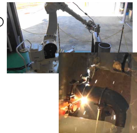
レーザー切断による炉内構造物の遠隔解体(イメージ)
