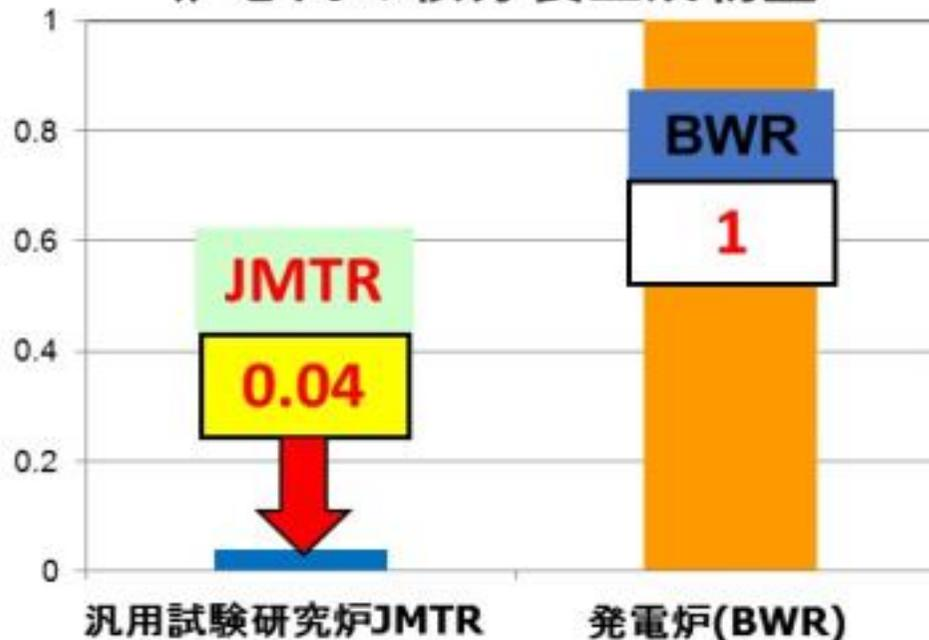
炉心には、ウランの核分裂により核分裂生成物(FP)がたまります。発電炉のFP量を1とすると、JMTRのFP量は**0.04**程度です。
