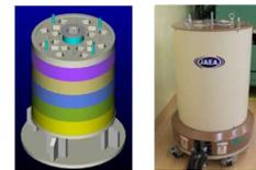
ZnS/<sup>10</sup>B<sub>2</sub>O<sub>3</sub>セラミックシンチレータ中性子検出器ユニットを含めた非破壊装置
