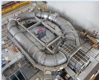
コールド試験中のTFコイル1号機
