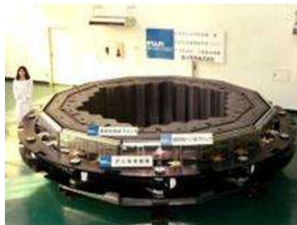
固定反射体、炉心拘束機構の工場組立試験
