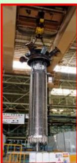
原子力用構造材として世界最高温度(950°C)で使用できる金属材料。HTTRの中間熱交換器に採用。
