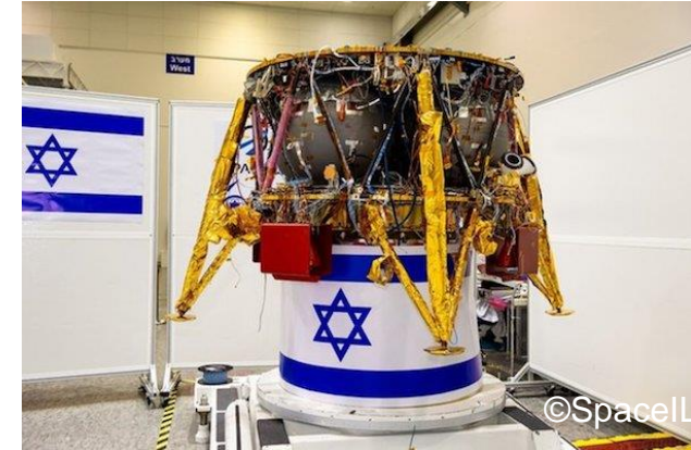
Beresheetフライトモデル。 直径2m、高さ1.5m程度、質量585kg(推葉込)
