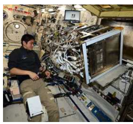
静電浮遊炉でのセッティング
