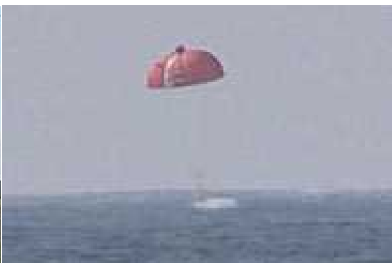
小型回収カプセルの高空落下試験
