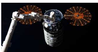
ISSロボットアームでの「シグナス」ドッキング作業
