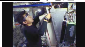
実験ラックの設置
