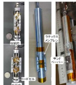
小林（福井大学）らによる月面地盤調査装置。地上と同等な測定を無人で実現できる。そのため地上データと直接比較可能。
