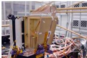
米国LROの放射線影響測定用宇宙望遠鏡 (CRaTER: Cosmic Ray Telescope for the Effects of Radiation) 銀河宇宙線の月周辺の空間マッピングを行っている。
