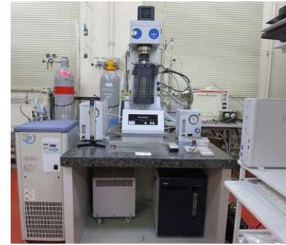
機械物性測定用に整備した弾性挙動測定装置(左)、
