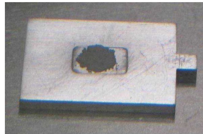
電気化学試験用に調製したCmCl 3 試料
