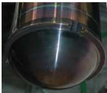
照射試験後のビーム窓部
