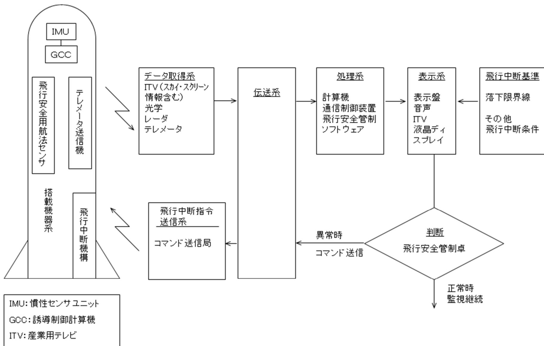
図7 飛行安全システム概念図
