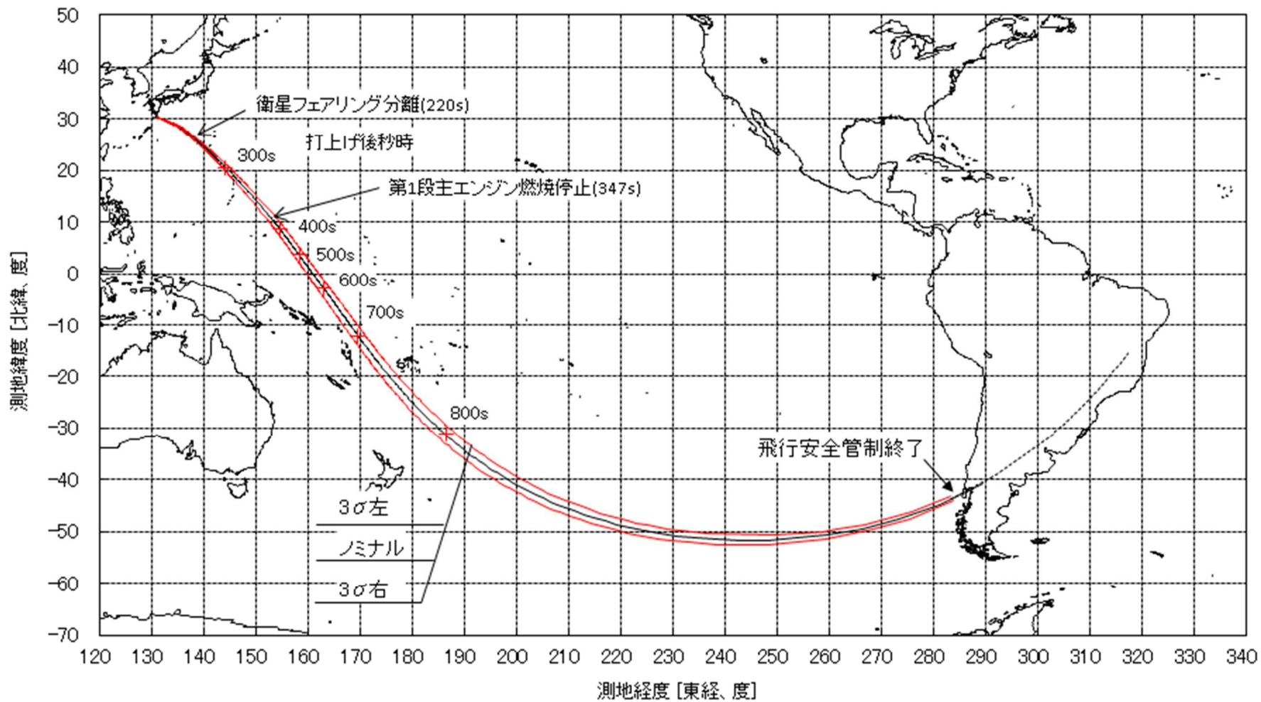
図6 ロケットの落下予測点<sup>(注)</sup>軌跡と3 $\sigma$ 分散範囲
