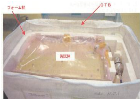
打上げ用バッグに梱包された状態で打ち上げられ、打上げ荷重を受ける
