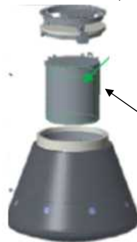
図 HTV搭載小型回収カプセルと与圧隔壁の関係
