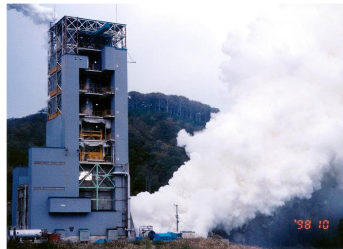
第1段厚肉タンクステージ燃焼試験 (三菱重工田代試験場)
