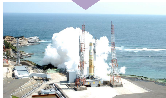
第1段実機型タンクステージ燃焼試験 (種子島宇宙センター)
