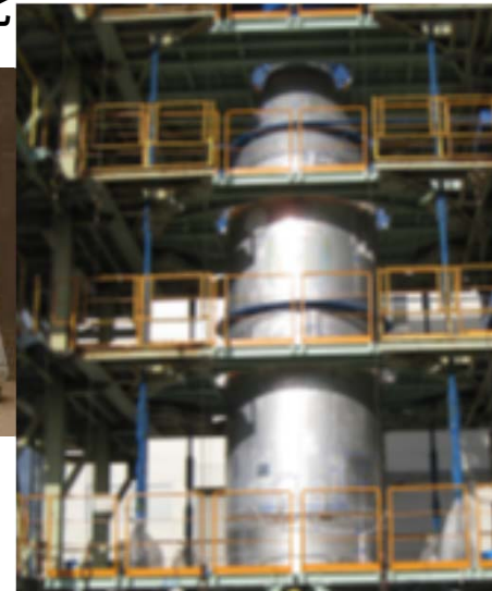
PM強度剛性試験@KHI播磨
